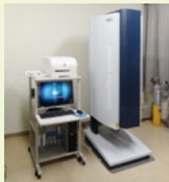
飛行時間測定型質量分析装置 物質の質量を測定するための装置
