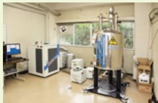
核磁気共鳴装置 分子構造を解析する装置
