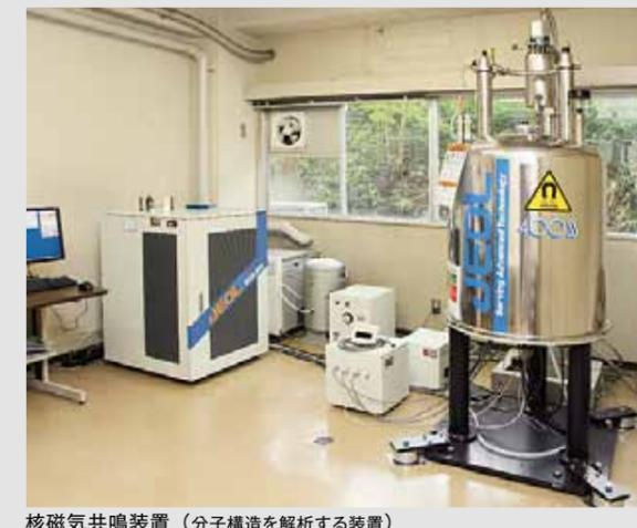
核磁気共鳴装置 (分子構造を解析する装置)
