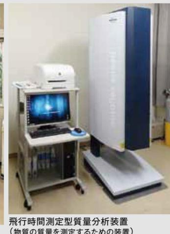
飛行時間測定型質量分析装置 (物質の質量を測定するための装置)
