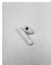
攪拌子 左：スタンダード型 (三角フラスコ用) 右：フットボール型 (二口ナスフラスコ用)
