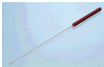
バイルシュタイン塩素検査棒 ※銅線の先に試料（塩素系ラップフィルム等）をつけ、炎の中に入れるだけです。ハロゲンが含まれていれば銅の炎色反応である鮮やかな緑色を観察することができます。
